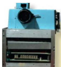
Le prototype du premier appareil photo numérique qui pesait 3,6 kg !
